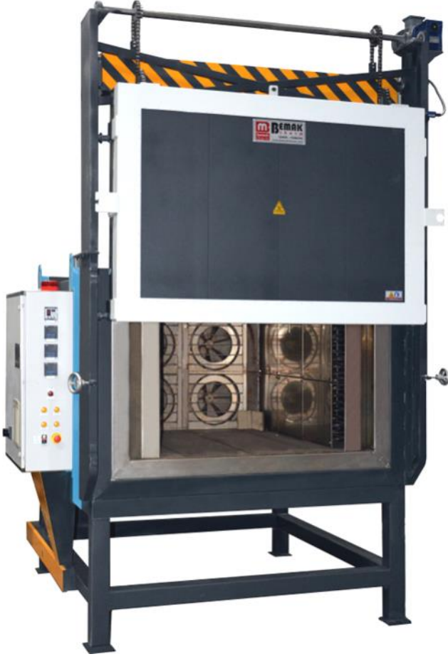
GİYOTİN KAPILI - HAVA SİRKÜLASYONLU - MENEVİŞ FIRINI GUILLOTINE DOOR - TEMPERING FURNACE
